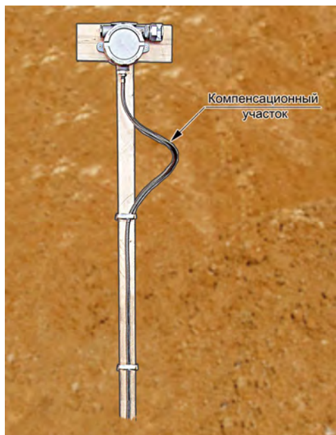
Рисунок 2.9 – Правильное положение головок ТС с соединительным кабелем на основе гибкого рукава в оплетке на месте их установки
